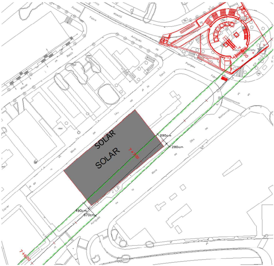
Imagen 2 – Trazado del túnel de la línea L9 en relación al solar
